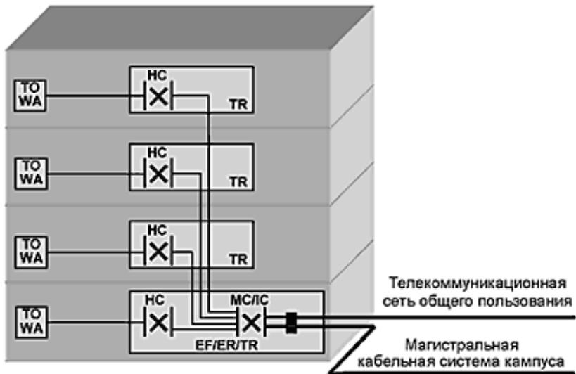
**Рисунок 6 - Расположение функциональных элементов кабельной системы в здании**
