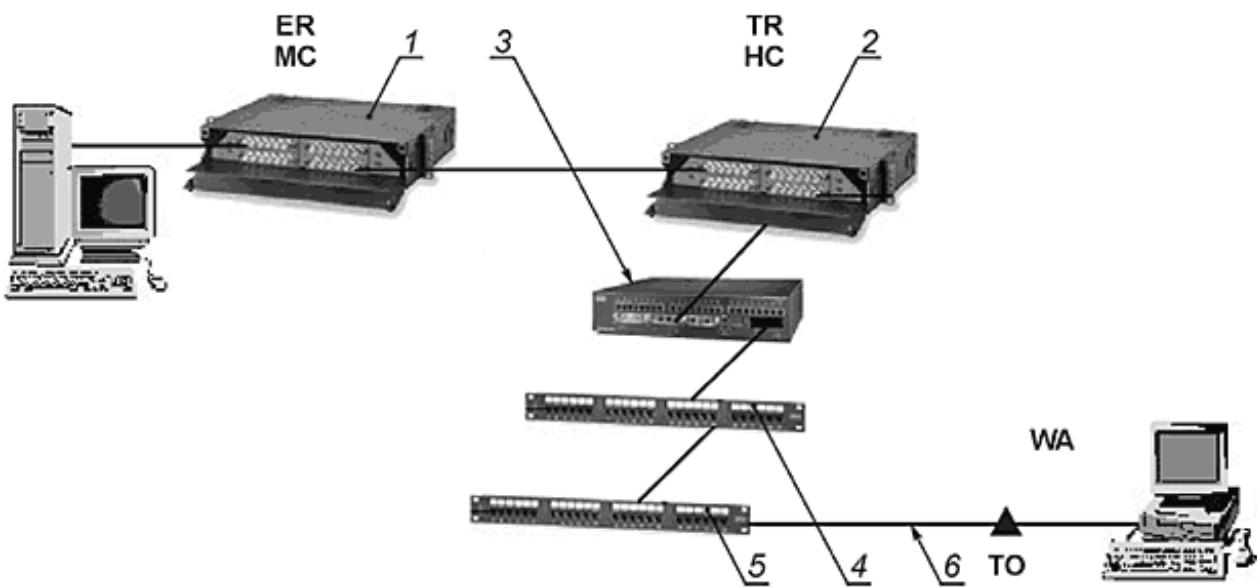
1 - аппаратный волоконно-оптический шнур в МС; 2 - магистральная волоконно-оптическая кабельная подсистема; 3 - аппаратный волоконно-оптический шнур в НС; 4 - аппаратный шнур с TELCO-коннекторами в НС; 5 - коммутационный модульный шнур в НС; 6 - горизонтальная кабельная подсистема
