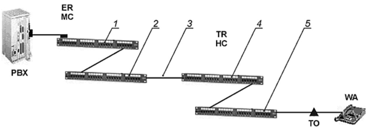
1 - аппаратный шнур с TELCO-коннекторами в МС; 2 - коммутационный модульный шнур в МС; 3 - магистральная кабельная подсистема; 4 - коммутационный модульный шнур в НС; 5 - горизонтальная кабельная подсистема
