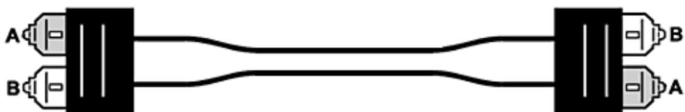
**Рисунок 11 - Волоконно-оптический коммутационный шнур типа 568SC**
