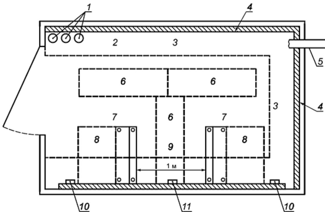
1 - три рукава диаметром 100 мм каждый (минимальное условие); 2 - распределительная система; 3 - лестничный кабельный лоток; 4 - монтажная плита, ДСП 20 мм; 5 - система связи телекоммуникационных, кондукт, калибр как минимум 3 (78 мм); 6 - потолочный светильник; 7 - аппаратная стойка; 8 - пространство доступа к питанию и системе заземления; 9 - технологическое пространство доступа; 10 - питание оборудования; 11 - вспомогательное питание
