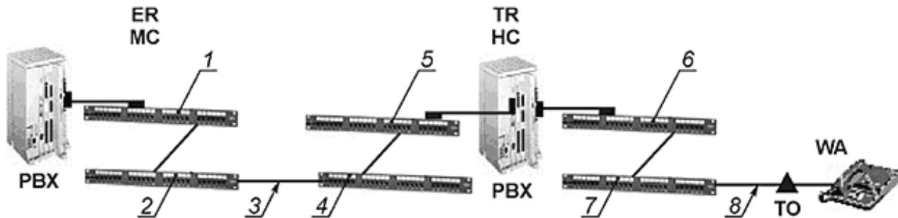
1 - аппаратный шнур с TELCO-коннекторами в МС; 2 - коммутационный модульный шнур в МС; 3 - магистральная кабельная подсистема; 4 - коммутационный модульный шнур в НС; 5 - аппаратный шнур с TELCO-коннекторами в НС; 6 - аппаратный шнур с TELCO-коннекторами в НС; 7 - коммутационный модульный шнур в НС; 8 - горизонтальная кабельная подсистема
