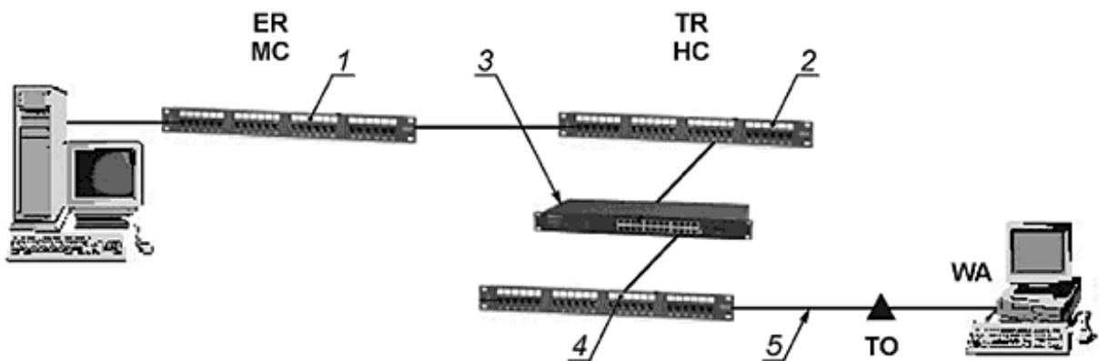
1 - аппаратный шнур с TELCO-коннекторами в МС; 2 - коммутационный модульный шнур в НС; 3 - коммутационный шнур к активному оборудованию в НС; 4 - коммутационный модульный шнур в НС; 5 - горизонтальная кабельная подсистема
